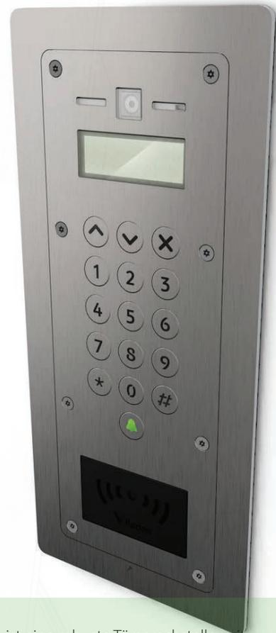
Die Entry-Türstation ist eine robuste Türsprechstelle, mit Eintritts und Zutrittskontrollfunktionen. Es wird über Power-over-Ethernet (PoE) mit Strom versorgt und kommuniziert mit den anderen Elementen des Systems über IPv6, so dass eine „Plug-and-Play“-Installation möglich ist. Jede Türstation ist mit einer Entry-Steuereinheit verbunden, die die Schnittstelle zur Tür-Hardware bildet.
